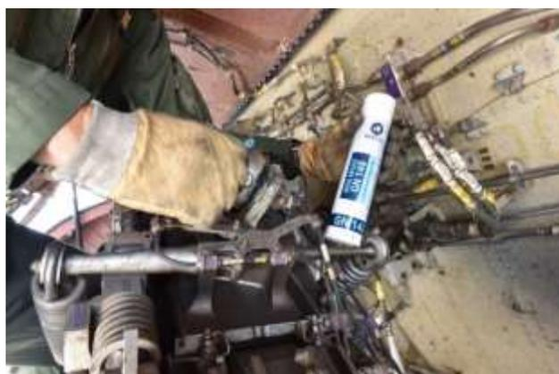
Un technicien utilisant une graisse multi-usage
